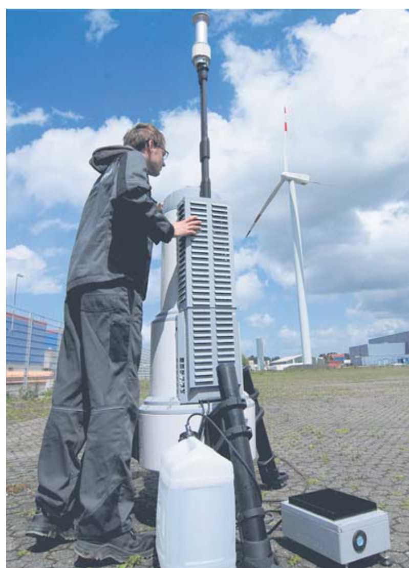
Powerwind-Projektleiter Philipp Degenhardt schaut nach, ob das neue Lidar-Gerät einwandfrei funktioniert. Es misst mit einem Laserstrahl die Windstärken an der PW90, die im Hintergrund steht. Foto maf
